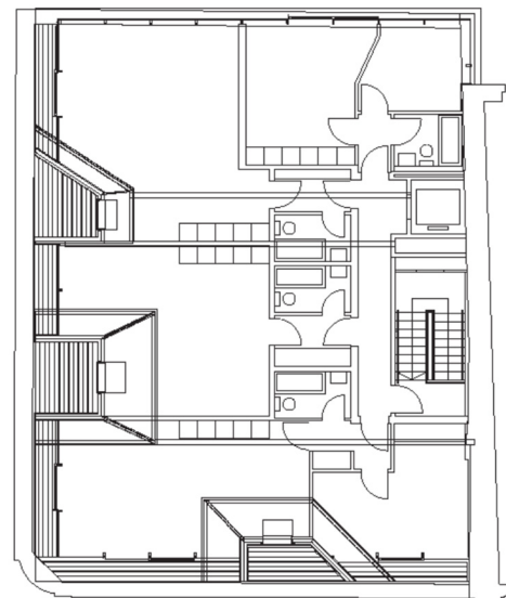
Abb. 48: Grundriss der Aufstockung
