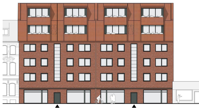
Abb. 21: Straßenansicht mit Aufstockung
